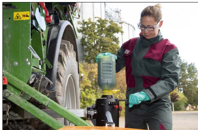
Plniace zariadenie PENTAIR kompatibilné s uzáverom EASYCONNECT namontované na postrekovači AMAZONE PANTERA.
